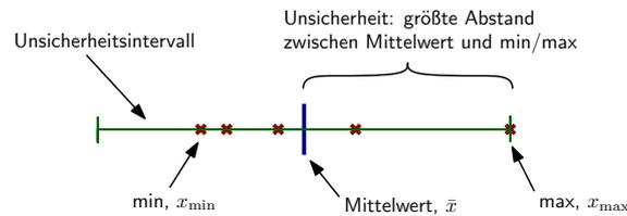
**Abbildung 6:** Grafische Darstellung der Berechnung der maximalen Abweichung. Die roten Kreuze sind die einzelnen Messungen, der blaue Balken zeigt den Mittelwert an, und die Messunsicherheit ist der größte Abstand zwischen dem Mittelwert und entweder dem Mindest- oder dem Höchstwert des Datensatzes. Der grüne Balken zeigt das gesamte Unsicherheitsintervall um den Mittelwert an.
